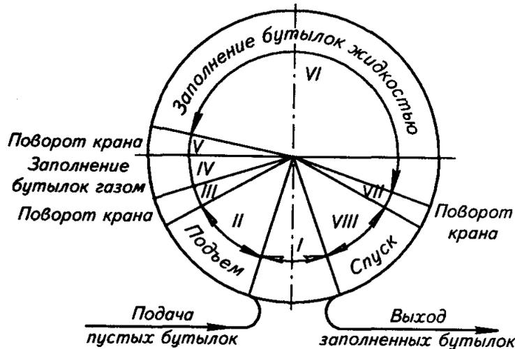
Рис. 1. Циклограмма работы разливочной дозирочной машины
